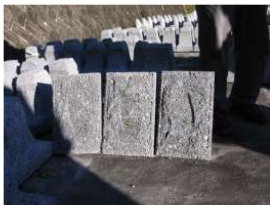
炭入りポーラスコンクリートブロック 植生導入を促進
